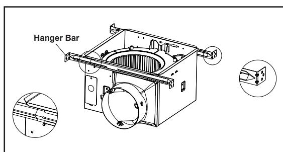
2. Déployer les barres de suspension jusqu'à la largeur de l'ossature. Positionner le ventilateur de manière à ce que le bord inférieur des pattes de la barre de suspension soit aligné avec le bord inférieur de l'ossature, en maintenant le ventilateur en place. Fixer les barres de suspension à l'ossature à l'aide d'une vis à chaque extrémité de la barre de suspension. Choisir un trou approprié et fixer les barres de suspension ensemble à l'aide d'une seule vis.
